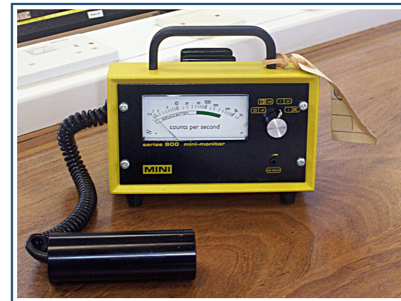
Contor Geiger-Müller – detectează radiațiile
